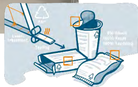
Kleiner Prototyp: Im Labor des Fraunhofer-Instituts für Werkzeugmaschinen und Umformtechnik in Dresden entsteht gerade eine Anlage, die zeigen soll, dass sich Papier auch ohne Klebstoff fest verbinden lässt.
