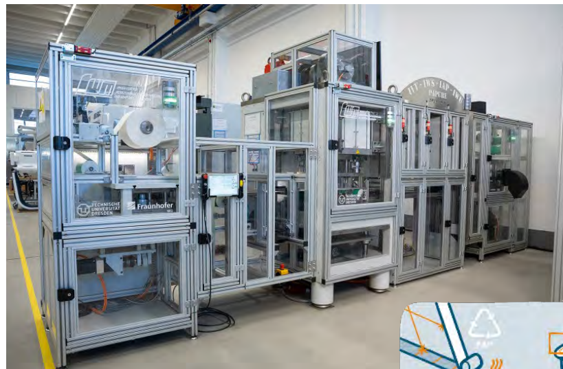
Kleiner Prototyp: Im Labor des Fraunhofer-Instituts für Werkzeugmaschinen und Umformtechnik in Dresden entsteht gerade eine Anlage, die zeigen soll, dass sich Papier auch ohne Klebstoff fest verbinden lässt.
