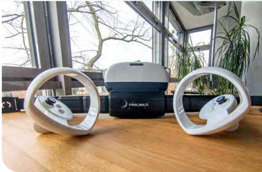
Mithilfe von haptischem Feedback gibt das Device das Frequenzspektrum des menschlichen Gehörs von 10 bis 20.000 Hz wieder.
