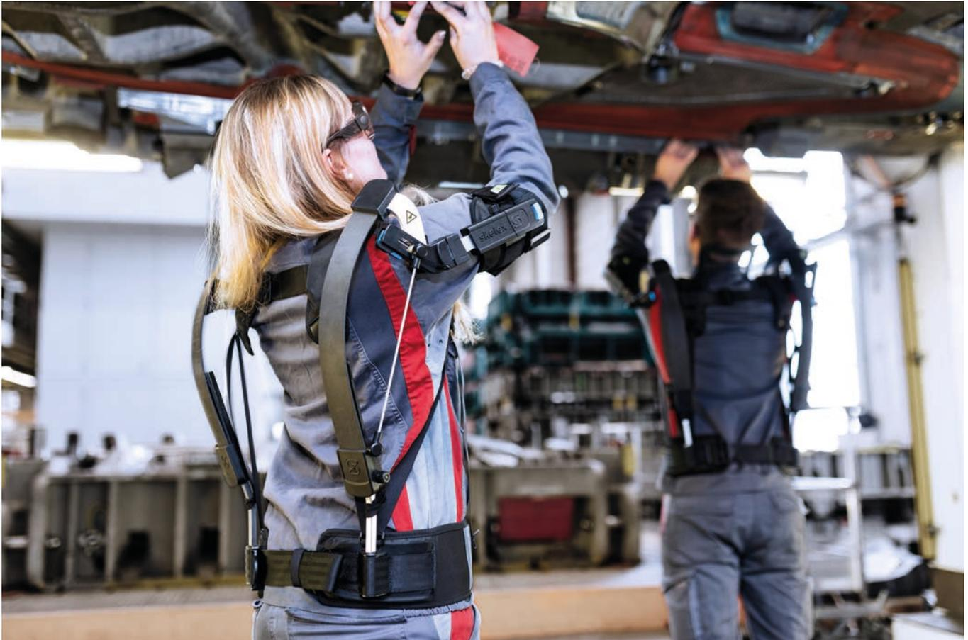
Exoskelette für Tätigkeiten im Überkopfbereich sollen Gelenk- und Muskulaturbelastungen der Mitarbeiter reduzieren. (Foto: Audi AG)
