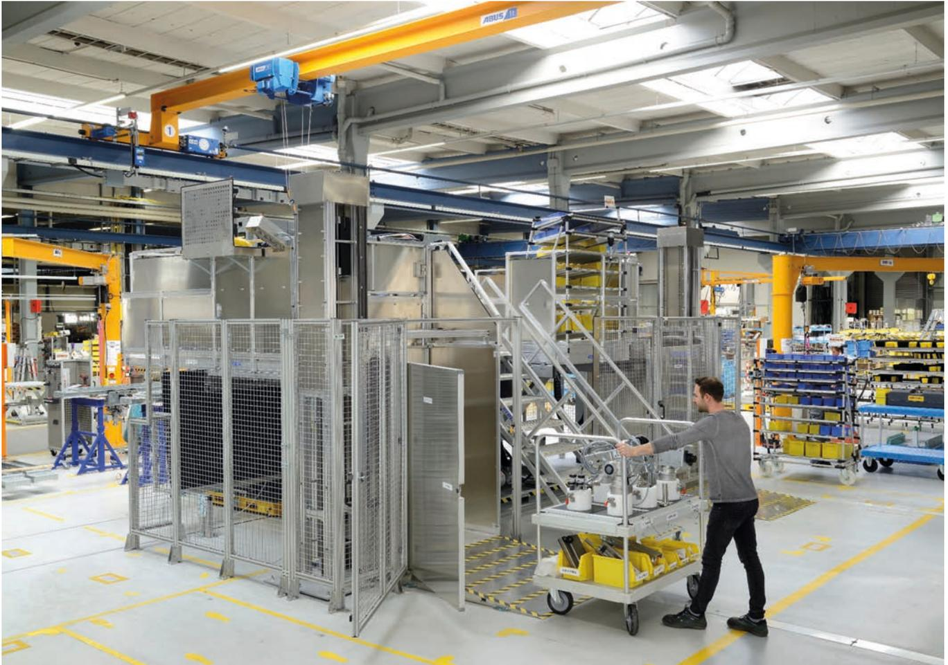
Für die Montage benötigtes Material wird in speziell entwickelten Transportwagen auf die gewünschte Arbeitshöhe gebracht. (Foto: Hymer)
