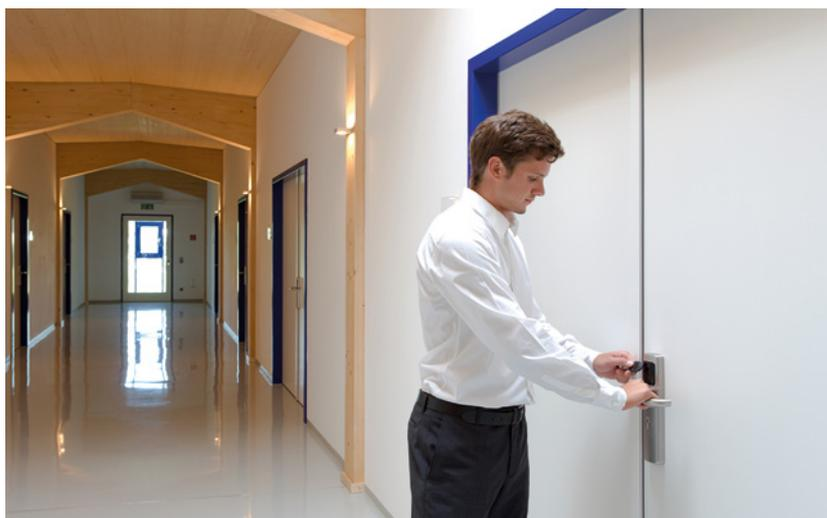
Zutrittssteuerung mittels Transponder [Foto: © PCS Systemtechnik]
